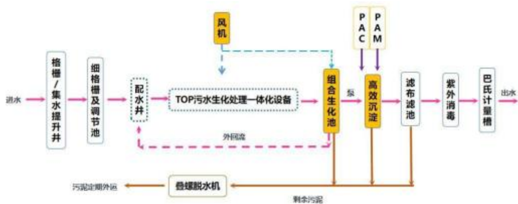
图 4-2 污水处理工艺流程图
