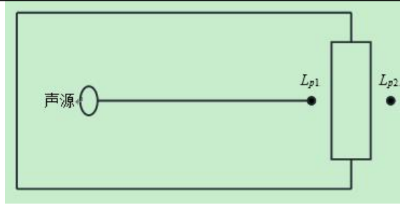
图 4-2 室内声源等效为室外声源图例
