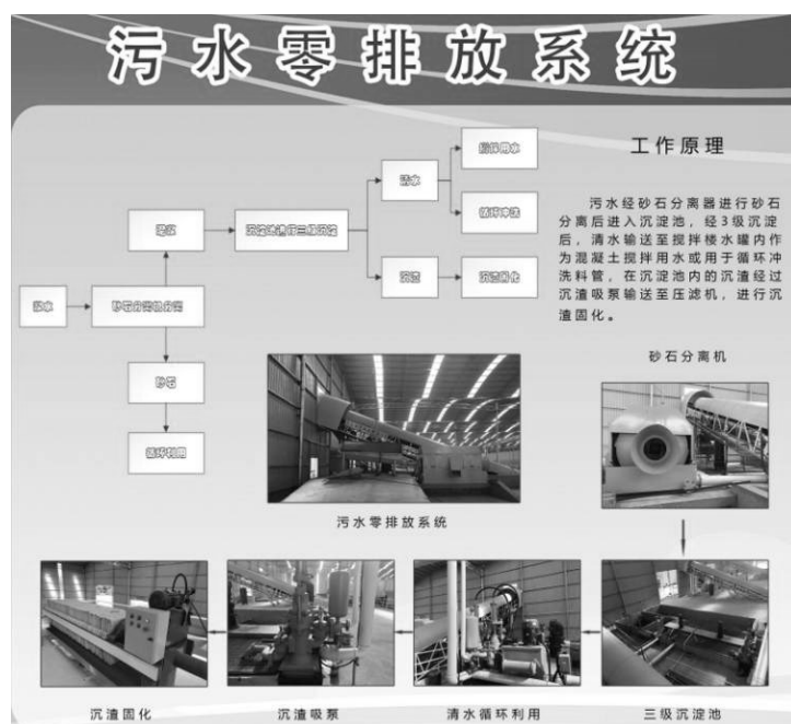
图 7-2 生产废水回用系统示意图
